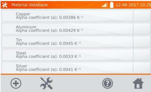
Im Messgerät sind standardmäßig 5 Materialien und deren Widerstandstemperaturkoeffizienten im Speicher hinterlegt: Kupfer, Aluminium, Zinn, Stahl und Silber. Mit **+** fügen Sie einen neuen Materialsatz hinzu.
